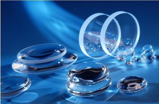
Германатные — ближайшие аналоги силикатных. Высокая цена и небольшая химическая стойкость существенно ограничивают их применение. Имеют хорошее преломление и светопропускание. Используются для оптических приборов.
