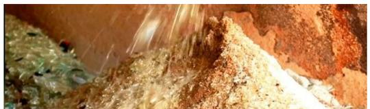
Стекло производится путем охлаждения расплавленных при температуре от  $+300$  до  $+2500$  °С компонентов, с достаточной скоростью, чтобы предотвратить образование видимых кристаллов. Одного песка достаточно для изготовления стекла, однако температура, необходимая для его плавления, будет намного выше. По этой причине сода добав-
