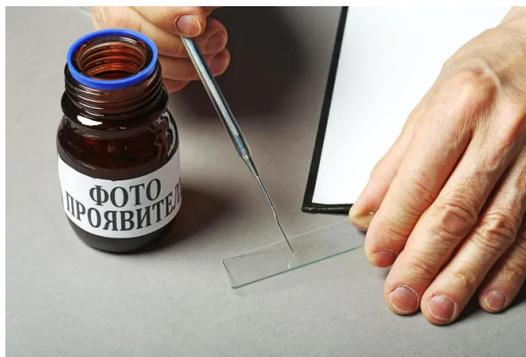
А вначале необходимо приготовить небольшой кусочек целлофана, для чего подойдет обычная пищевая пленка или кусочек обертки от сигаретной пачки. Целлофан размачиваем в чистой воде, затем наклеиваем на стеклянную пластинку с помощью желатинового клея и высушиваем. После сушки приходит время формирования слоя.
