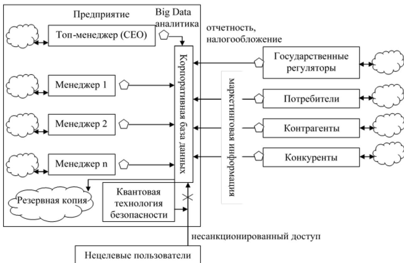
Рисунок 2 – Концептуальная модель управления корпоративными базами данных на базе облачных, квантовых, блокчейн-технологий и технологий обработки больших данных на принципах эффективности и безопасности
