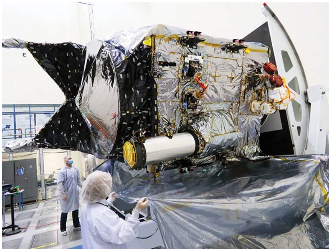
Технология Deep Space Optical Communications от NASA, установленная на космическом аппарате Psyche, в настоящее время тестирует лазерную связь за пределами Луны. На этом снимке Psyche перед запуском, приемопередатчик расположен (хотя его и не видно) справа от трубчатого солнцезащитного козырька DSOC. Фото: JPL-CALTECH/NASA
