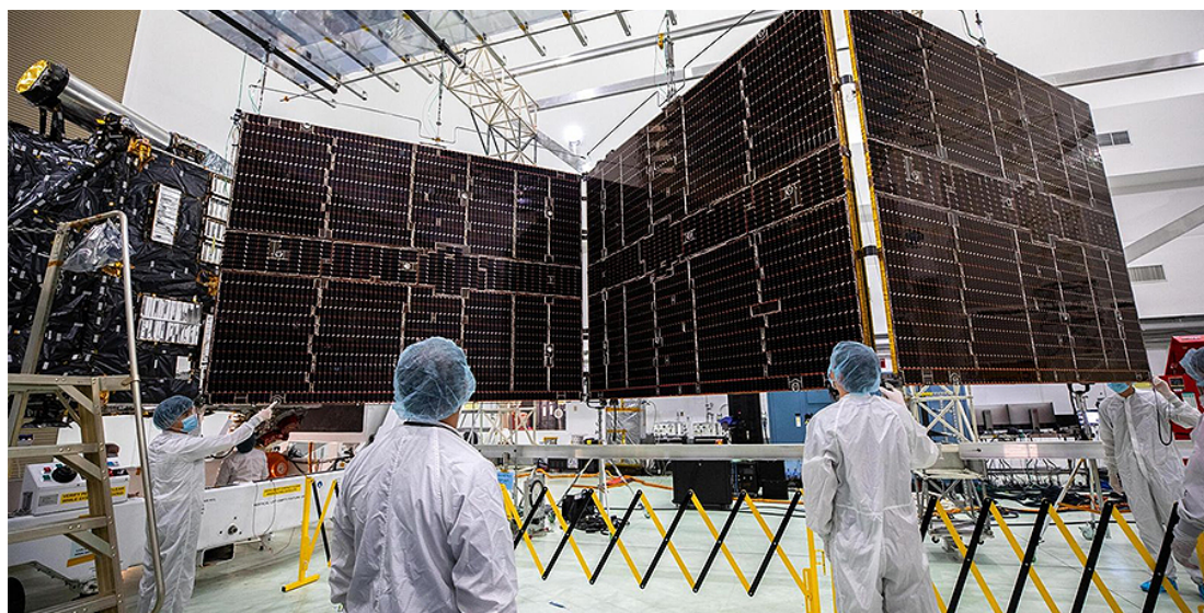
Одна из двух солнечных батарей, установленных на космическом аппарате NASA Psyche. Фото: NASA/Kim Shiflett
