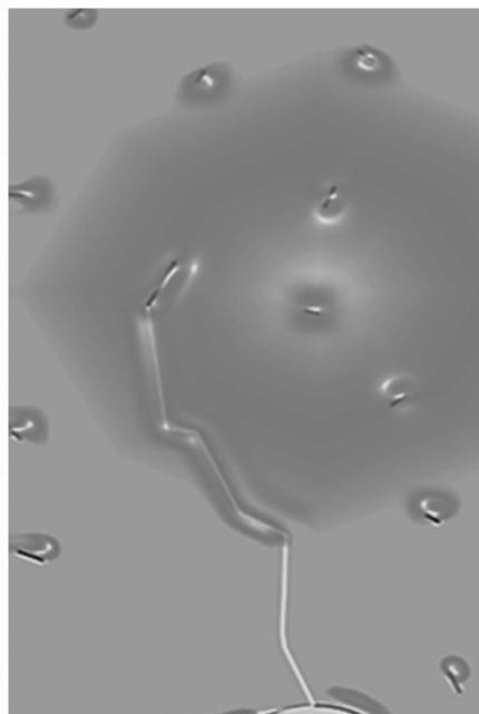
*Сравнительные изображения выявленного экспериментально роста трещины и визуального моделирования процесса разрушения бетона, модифицированного оксидом графена. Источник: Валерий Лепов*
